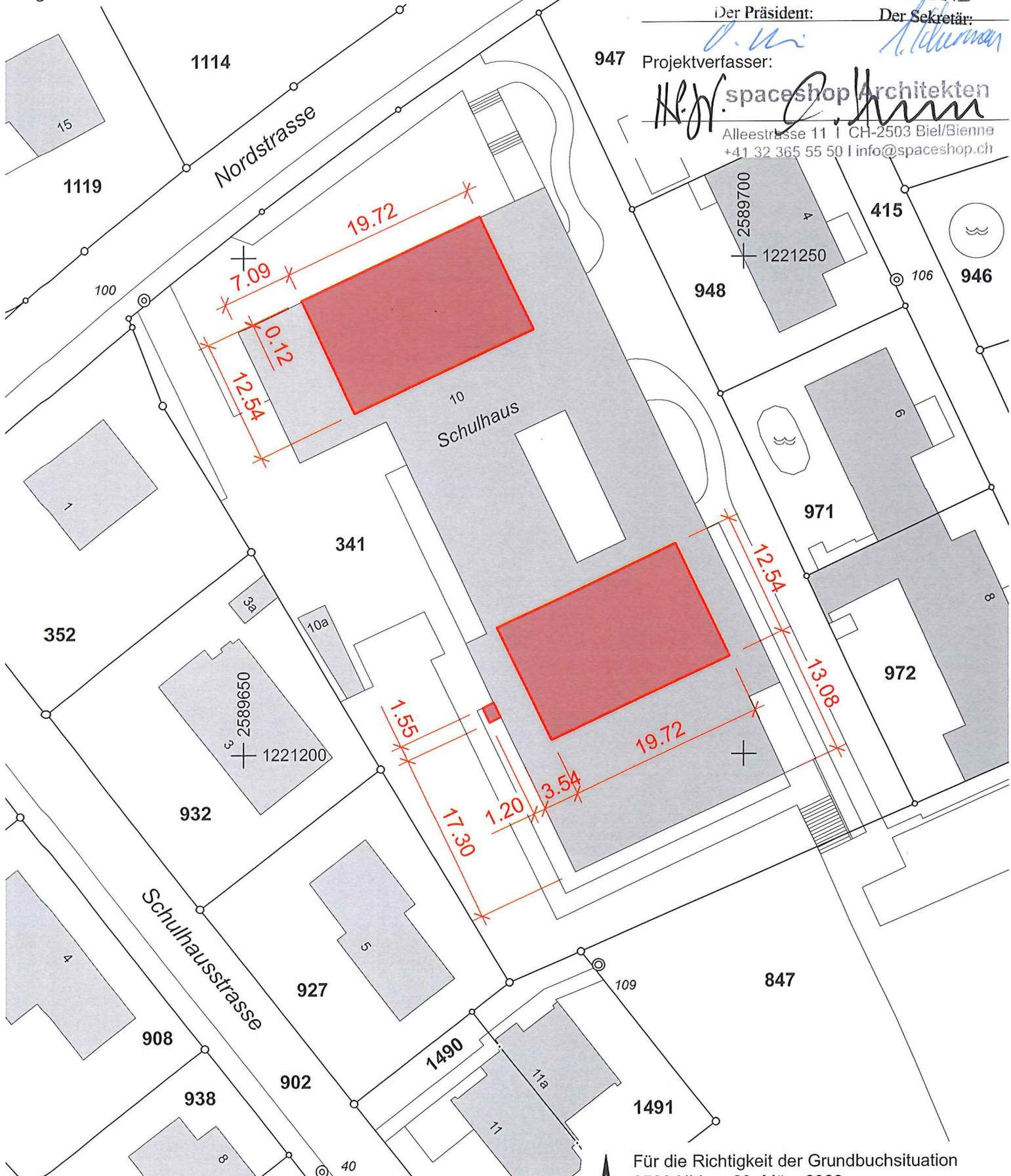
Daten aus der amtlichen Vermessung und Baulinien haben entsprechende Toleranzen. Müssen bei Projektierungen Abstände (z.B. Grenz-, Gebäude-, Strassenabstände, etc.) im cm-/dm-Bereich ausgenützt werden, so ist auf jeden Fall vorgängig im Feld zu messen, die Aktualität und bei Baulinien auch die Übereinstimmung mit den rechtsgültigen Plänen (z.B. ÖREB-Kataster) zu prüfen.
