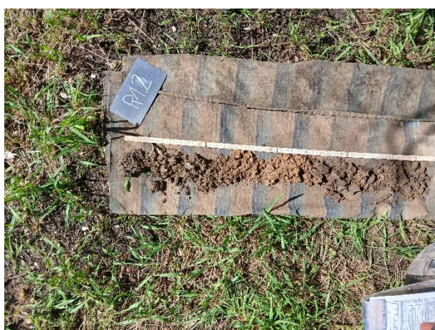
Foto 6: Referenzbohrung R1.2: Auffüllung
