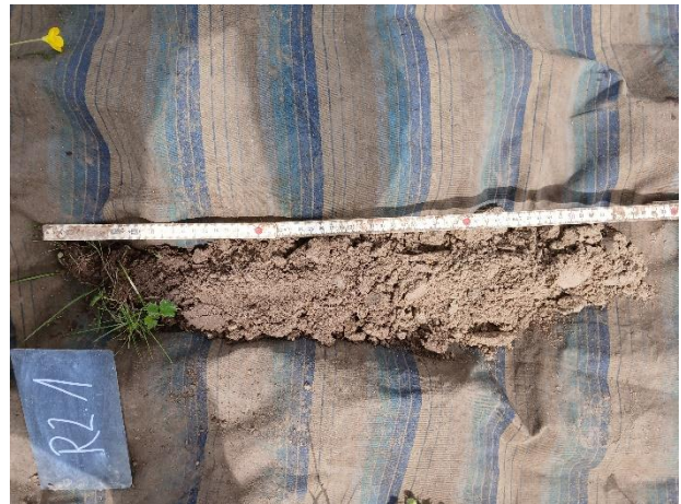
Foto 12: Referenzbohrung R2.1: Auffüllung
