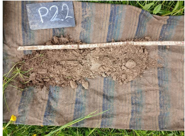
Foto 14: Referenzbohrung R2.2: Auffüllung
