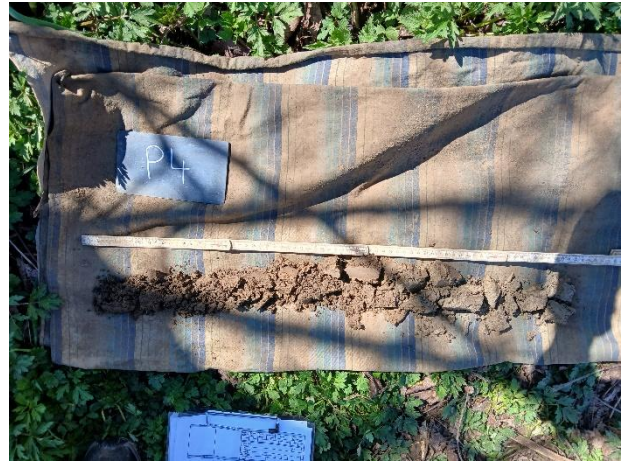
Foto 8: Referenzbohrung P4: Braunerde
